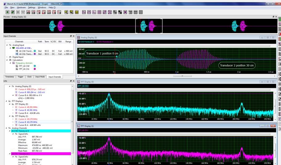
Abbildung 1: SBench 6 – ein leistungsstarkes, interaktives Softwaretool für die Aufzeichnung und Analyse von Digitizer-Daten
